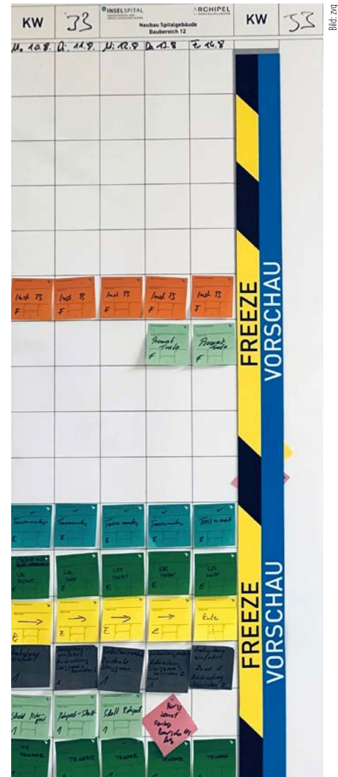
Bei der wöchentlichen Produktionsplanung sind den einzelnen Gewerken jeweils Farben zugeordnet, was die Übersichtlichkeit erhöht.
